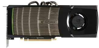
(b) GTX 480 (laboMAT et labo- STAT) : 480 coeurs, 1.4 GHz, 1.5 Go GDDR5
